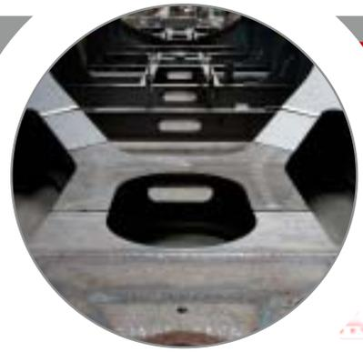
SPJ SV sa v poslednom období podarilo nadviazať spoluprácu s renomovanými spoločnosťami pôsobiacimi v náročnom segmente osobnej železničnej dopravy. Konkrétne sa jedná o výrobu zvarencov kabínových modulov a kostier spodku električiek. Po zvládnutí nábehov výroby a rozbehu sériových dodávok, ktorým sme sa venovali v priebehu predošlého roka, je zámer pôsobenie v tomto segmente ďalej rozširovať.
