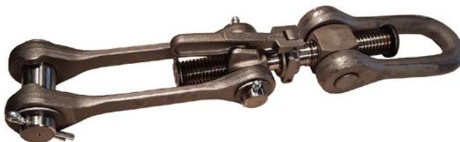
Skrutkovka je mechanický systém slúžiaci k spojeniu s ťahlovým hákom susedného železničného vozidla.
